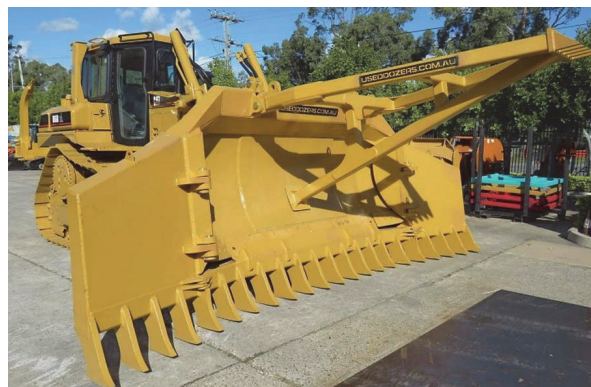
Obr. 64 Dozer s rozrývačem a porážecem stromů
