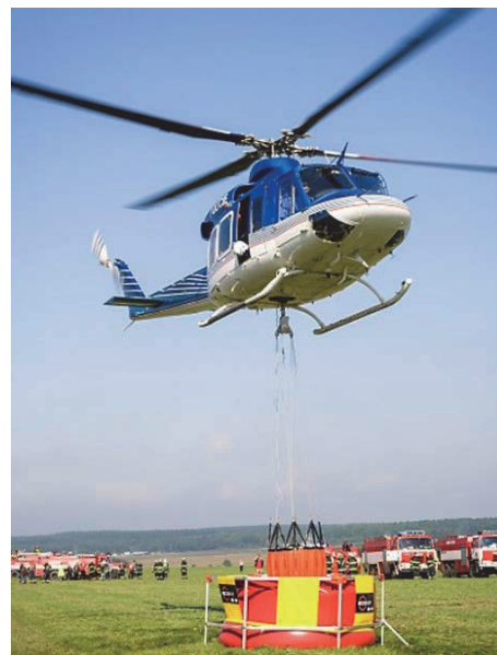
Obr. 77 Plnění vaku z mobilní nádrže
