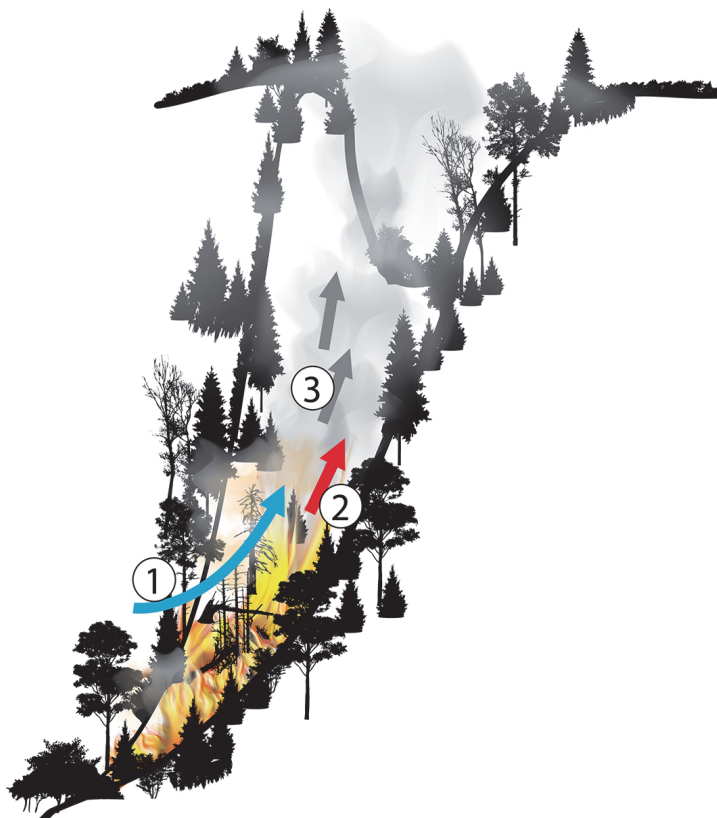
Obr. 30 Komínový efekt v ostrém zářezu v krajině 1 – proudění čerstvého vzduchu, 2 – šíření požáru, 3 – odtah kouře, pásmo přípravy hoření
